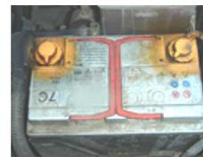
Batterie : après application de la protection sur les bornes et connexions : celles-ci conserve un coloration jaune, pas de fuite d'acidité bonne protection et isolation
