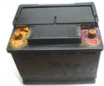
Batterie non protégée : après application de la protection sur les bornes et connexions une coloration rouge apparaît ( fuite d'acidité )
